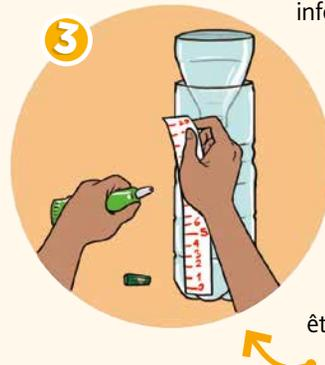
Colle la graduation sur la partie inférieure de la bouteille, le 0 correspondant au fond de la bouteille. Pose ta bouteille à l'extérieur, à un endroit exposé à la pluie. Veille bien à ce que la bouteille ne tombe pas. Elle doit être bien calée.
